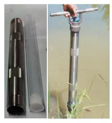
2. 如果是浅水采样需要加装推杆:可将头部组件把手两端的延长杆卸下,将推杆(如果需要加长则可以通过双螺口管箍将各推杆连接起来)安装到头部组件并安装好取样管等其他部件后再使用。同样只需将采泥器下放到水体中并向下将其插入底泥中即可采集样品。回收过程同样需要尽量保持采泥器的垂直状态。
